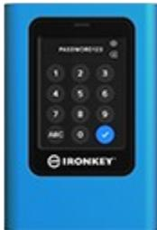
1. ブルートフォース攻撃保護では、Crypto Erase が実行されるまでのパスワード試行回数を 10～30 の間で調整できます。
