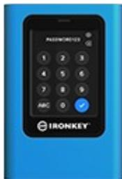
1. Cancellazione criptata del drive per la protezione da attacchi Brute Force con possibilità di impostare da 10 a 30 tentativi di immissione della password
